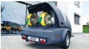
Geeignet für Fahrzeuge mit Anhängelast von mind. 1.500 kg. Tank mit hoher Kapazität, integriert in Leichtbau-Chassis für sicheres Manövrieren. TÜV-zugelassen, einachsrig, integrierte Bremse, Beleuchtung und Blinker. Lieferung mit europäischer Standardkupplung, Stützrad und Handbremse sowie Standfuß zur Standsicherheit. Mit EU-Konformität.
