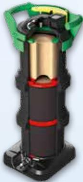
Das Wasser strömt durch Ionentauscherharz, welches die Feststoffe bindet. Somit wird ein hochreines Wasser erzeugt, das destilliertem Wasser ähnlich ist.
